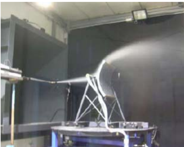
Fig. 17 - Prova in galleria del vento del modello di collettore
