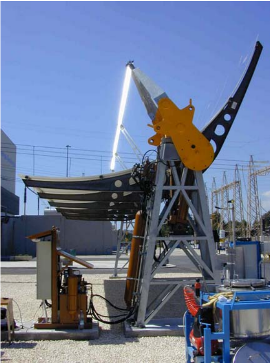
Fig. 21 - Sistema di movimentazione dei collettori
