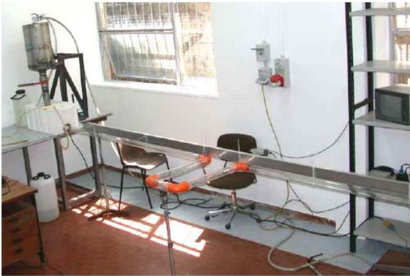
Fig. 34 - Allestimento PRODE per prove di deflusso sali
