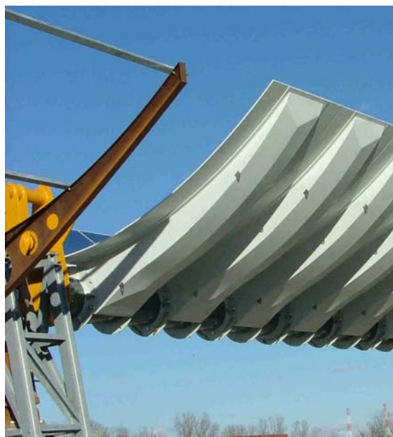
Fig. 20 - Specchi con supporto autoportante (Faini) in prova su MPBT
